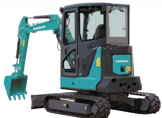
AX38u-6A Operationeel gewicht 3,960kg Vermogen 0.10m 3 Rubberen rupsbanden, cabine
