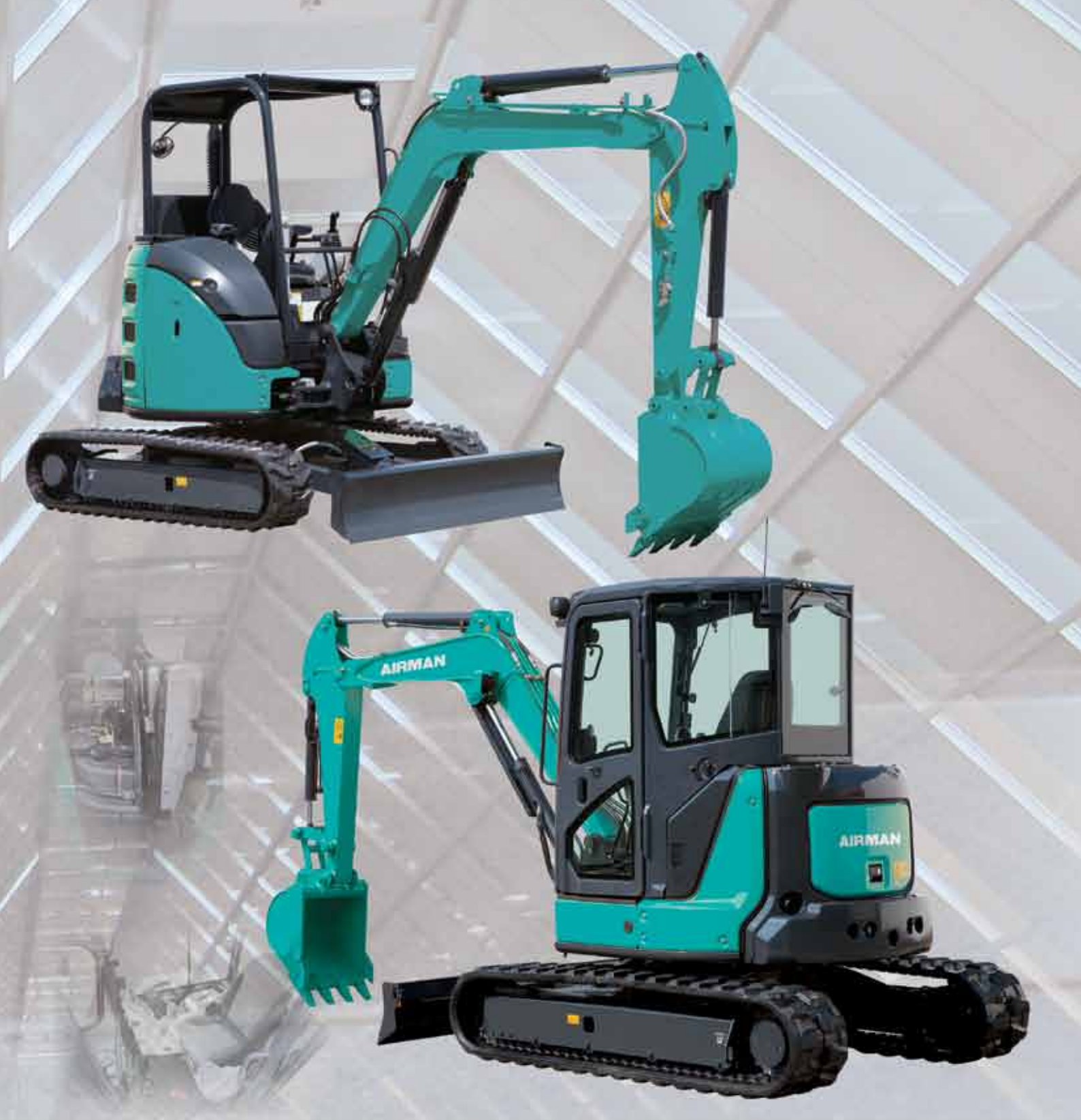
AX48u-6A Operationeel gewicht 4,770kg Vermogen 0.11m 3 Rubberen rupsbanden, Kap op vier steunen
